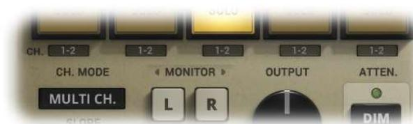
Se o "Ch. Mode" estiver definido para **multi canal**, o ISOL8 copia a banda dividida para um dos cinco pares de canal/bus.
